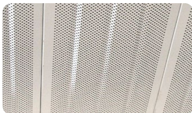
Cassete 60 com perfuração total (13,64%), diâmetro do furo de 4,75 mm, distância entre centros de 12,2 mm, diagonal.
